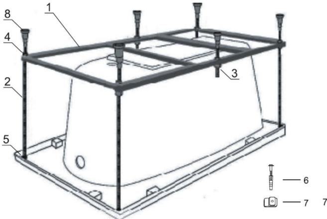
3. Setzen Sie den Stift (2) in das Rahmenloch ein, und schrauben Sie den Stift auf die Kunststoffstützen (5).
